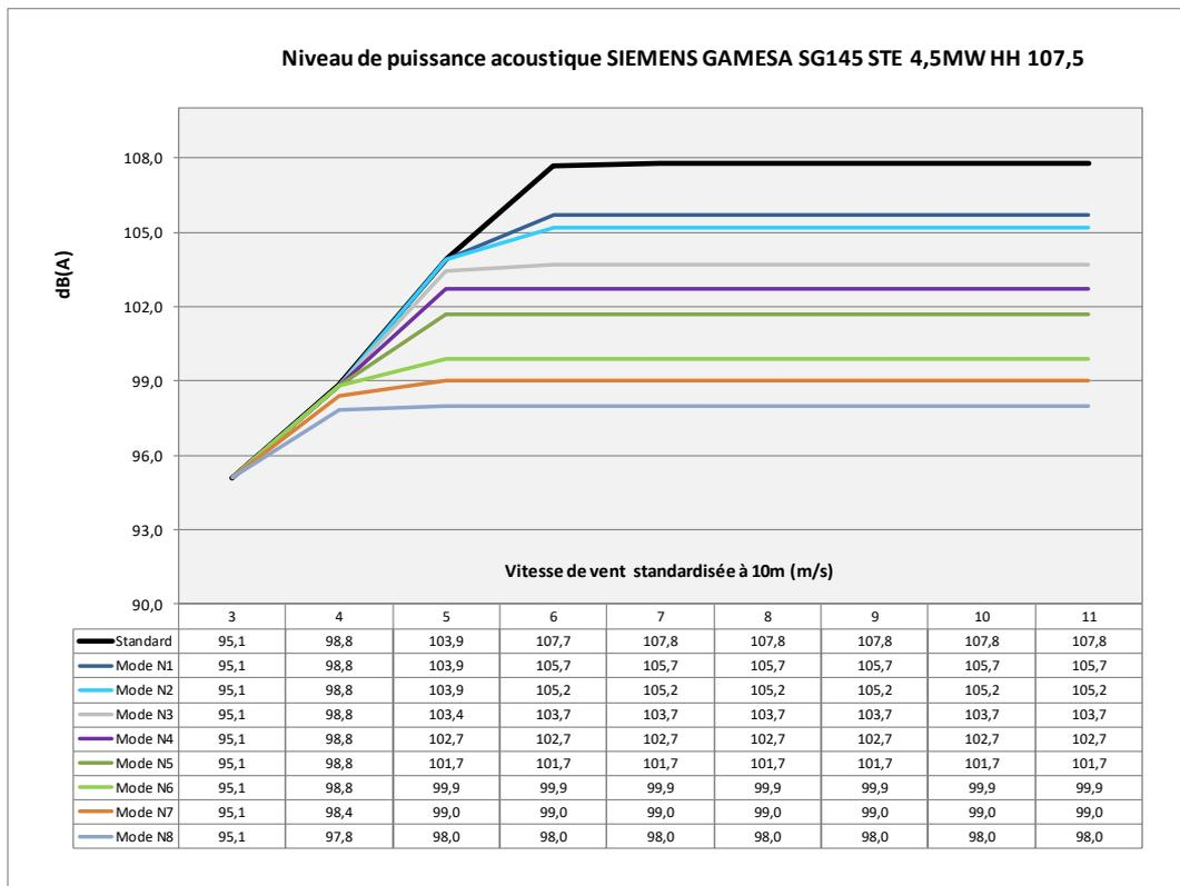
Figure 48 : Modes de fonctionnement SIEMENS GAMESA SG145 STE 4,5MW HH = 107,5 m
