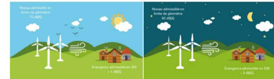
Figure 1 : Illustration des niveaux émergences admissibles (source : Sixerce Environnement, 2019)
