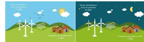
Figure 2 : Illustration des niveaux émergences admissibles (source : Sixence Environnement, 2018)
