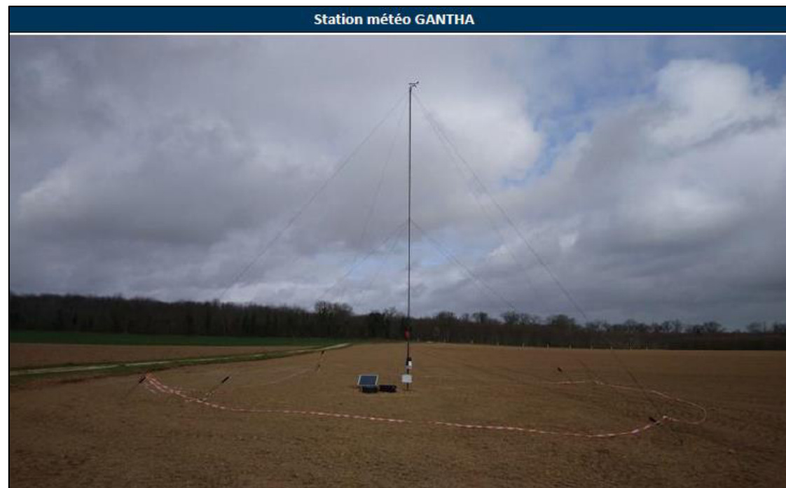
Figure 308 : Station météorologique sur pied à 10 m du sol – Mesures hivernales (Source : Étude d'impact acoustique de GHANTA)
