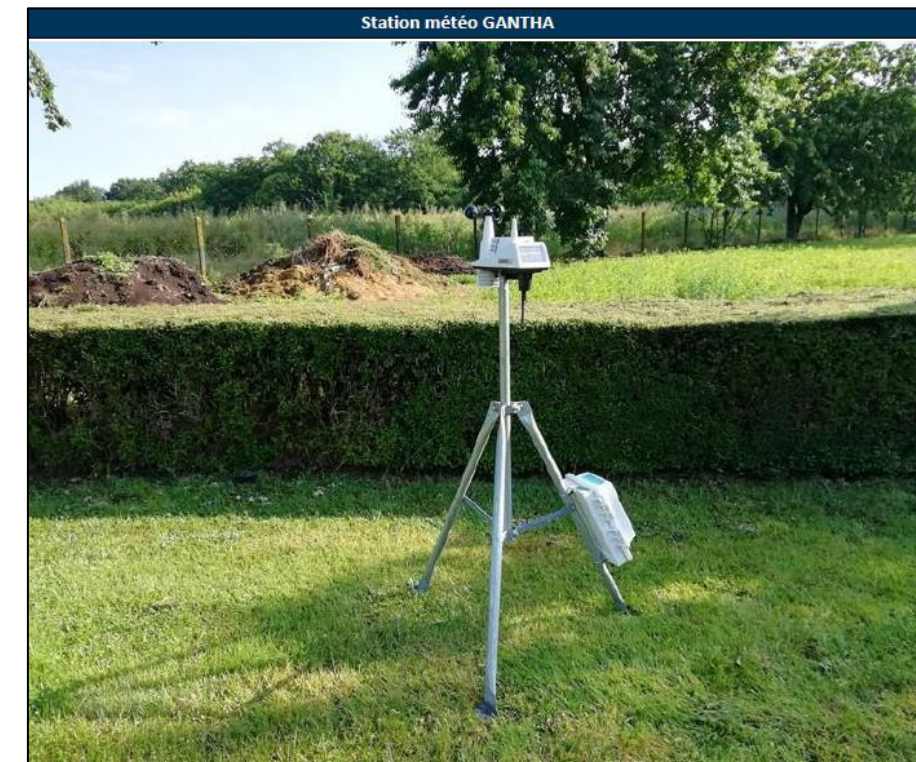
Figure 309 : Station météorologique sur pied à 1,5 m du sol – Mesures estivales (Source : Étude d'impact acoustique de GHANTA)
