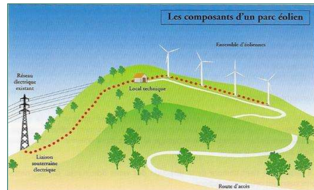
Figure 60 : Les composants d'un parc éolien
