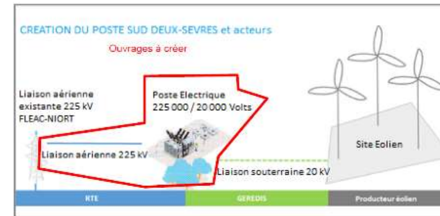
Figure 55 : Schéma de création du poste Sud Deux-Sèvres – Source : document de présentation RTE
