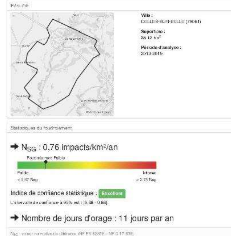
Figure 19 : Statistiques de foudroiement pour la commune de Celles-sur-Belle – Source : Météorage
