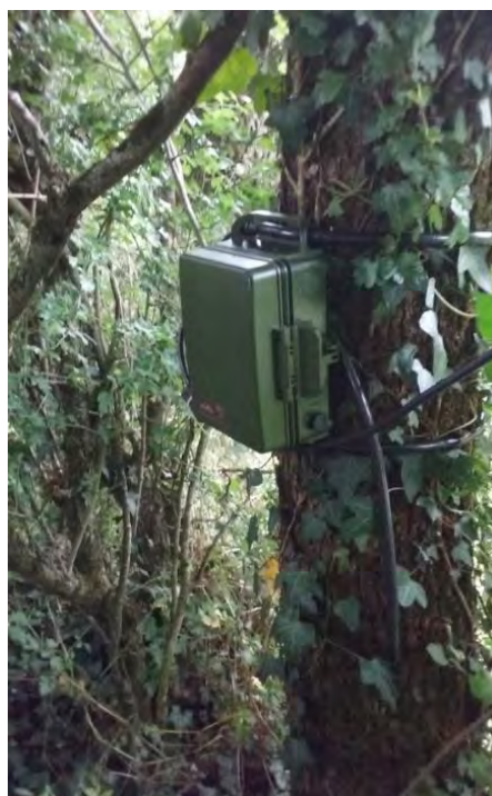
Figure 10 : Installation d'un enregistreur continu SM4BAT
