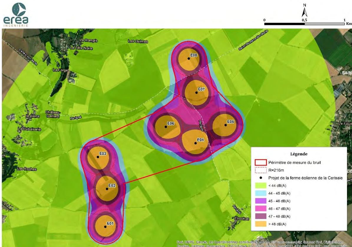
Niveaux sonores dans le périmètre de mesure de bruit de l'installation – VESTAS V136 de 112 m de hauteur nacelle en mode de fonctionnement normal pour la vitesse de vent standardisée de 10 m/s
