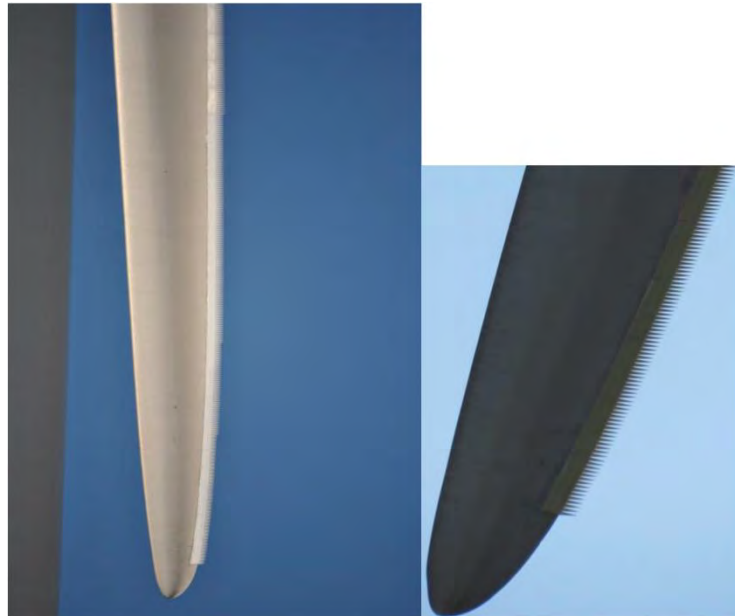
Illustrations du montage des peignes sur les pales d'une éolienne (source VESTAS : 0048-1259_V01 - STE Technical description)
