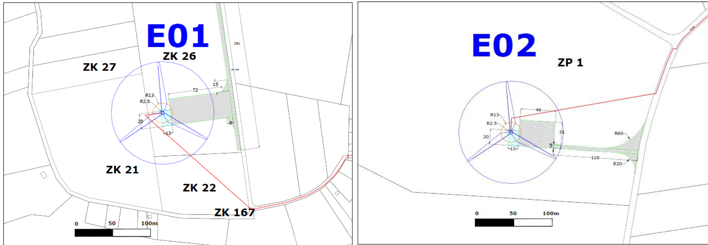
Figure 9 : Localisation de l'aire de montage pour chaque éolienne 1/2
