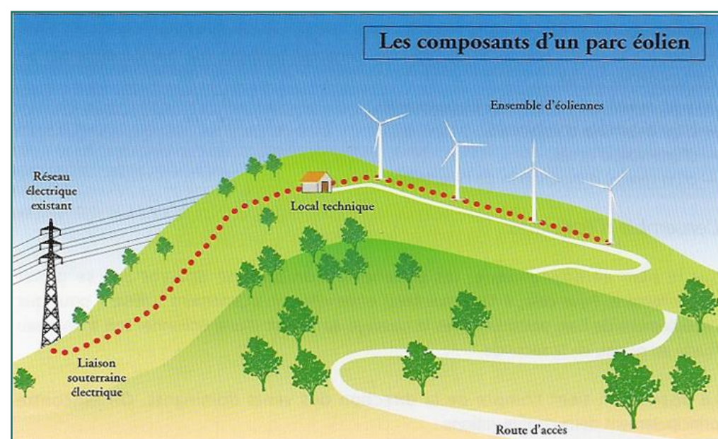
Figure 5 : Les composants d'un parc éolien
