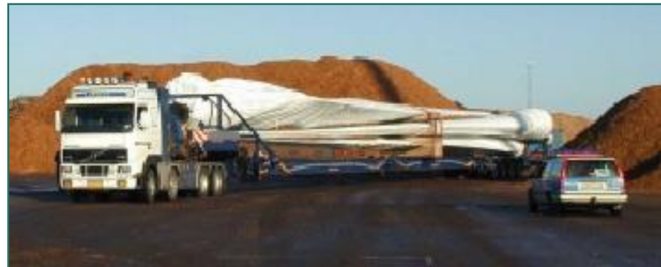
Photographie 1 : Transport sur remorque des pales
