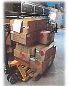
Stockage d'artifices sur une palette non filmée dans un bâtiment non autorisé (DREAL BFC)
