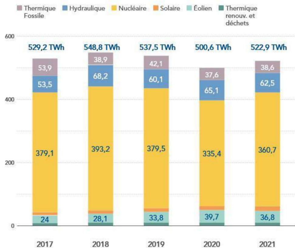
Figure 14 : Répartition de l'énergie produite entre 2017 et 2021 (source : RTE, Bilan 2021)
