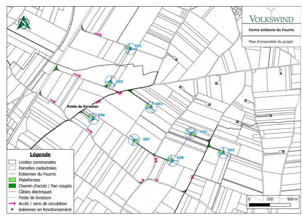
Implantation des éoliennes, des chemins d'accès et localisation du réseau électrique inter-éoliennes
