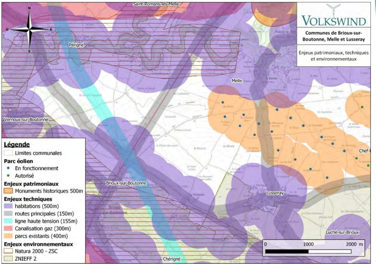
Les contraintes du projet éolien du Fourris et la zone d'implantation potentielle retenue
