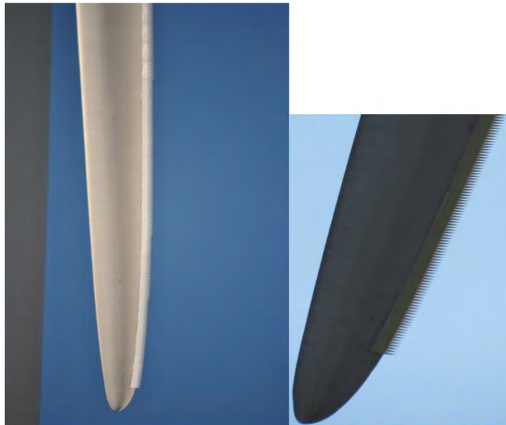
Illustrations du montage des peignes sur les pales d'une éolienne (source VESTAS : 0048-1259_V01 - STE Technical description)
