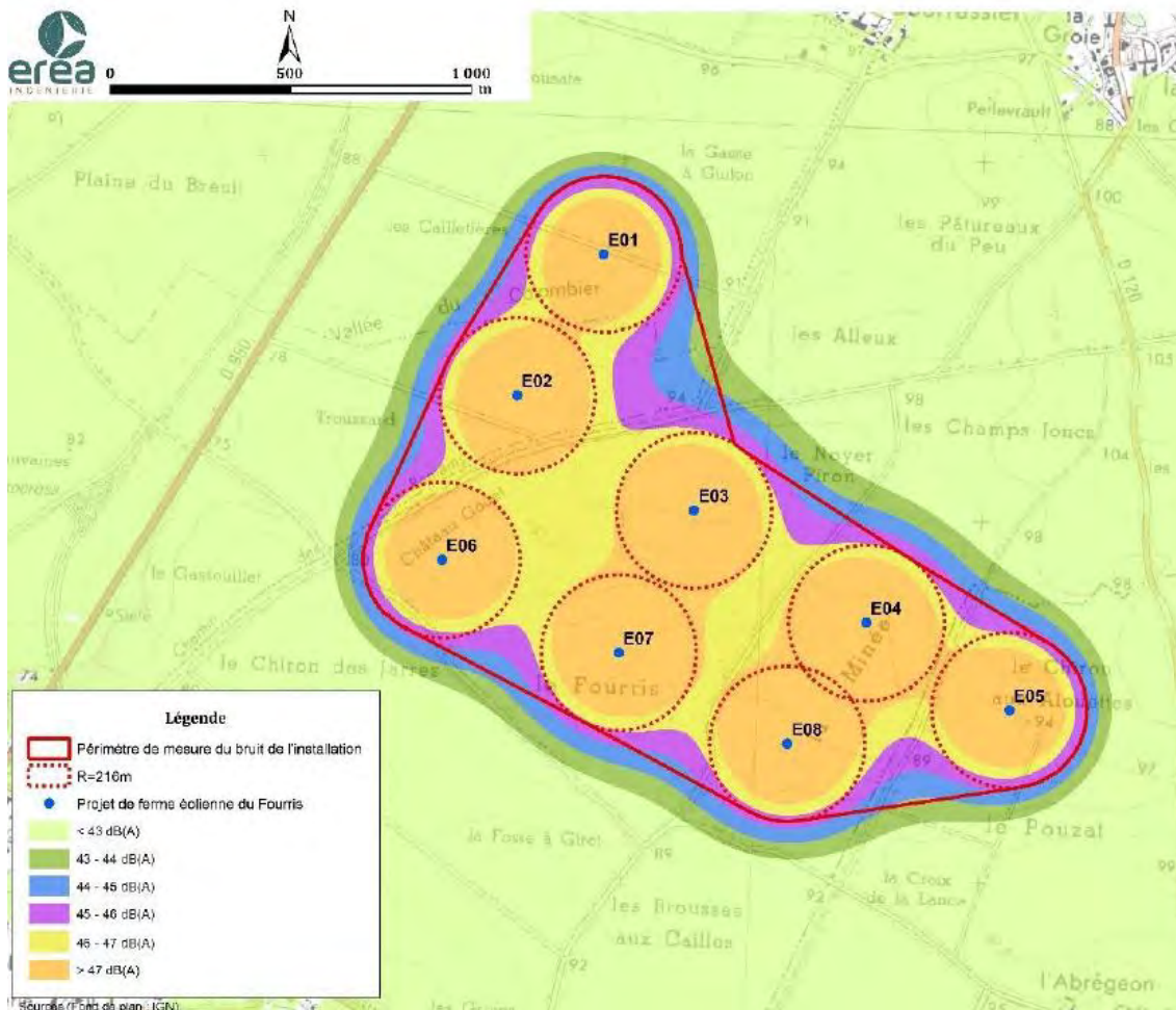
Carte 7 : Niveaux sonores dans le périmètre de mesure de bruit de l'installation – VESTAS V136 de 112 m de hauteur nacelle en mode de fonctionnement normal pour la vitesse de vent standardisée de 10 m/s
