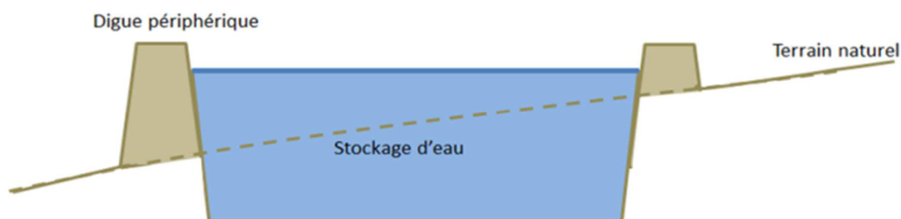
Exemple de retenue bâchée en remplissage
