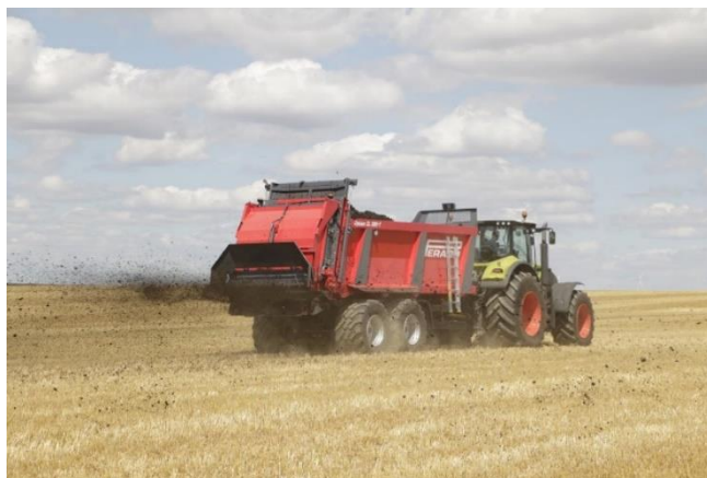
Figure 38 : Épandage avec un épandeur muni d'une table d'épandage
