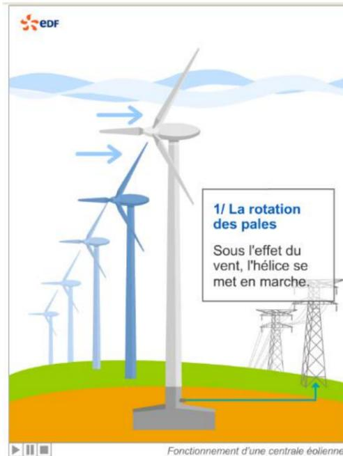
Le fonctionnement d'une éolienne est très simple et peut schématiquement s'apparenter au mode de fonctionnement d'une dynamo de vélo où la rotation de la roue est remplacée par celle du rotor, entraînée par les pales sous l'effet du vent.
