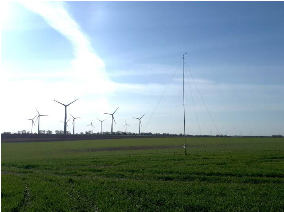
Photographie du mât de mesures météorologiques
