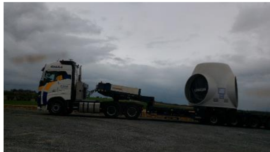
Figure 78 : Transport du moyeu
