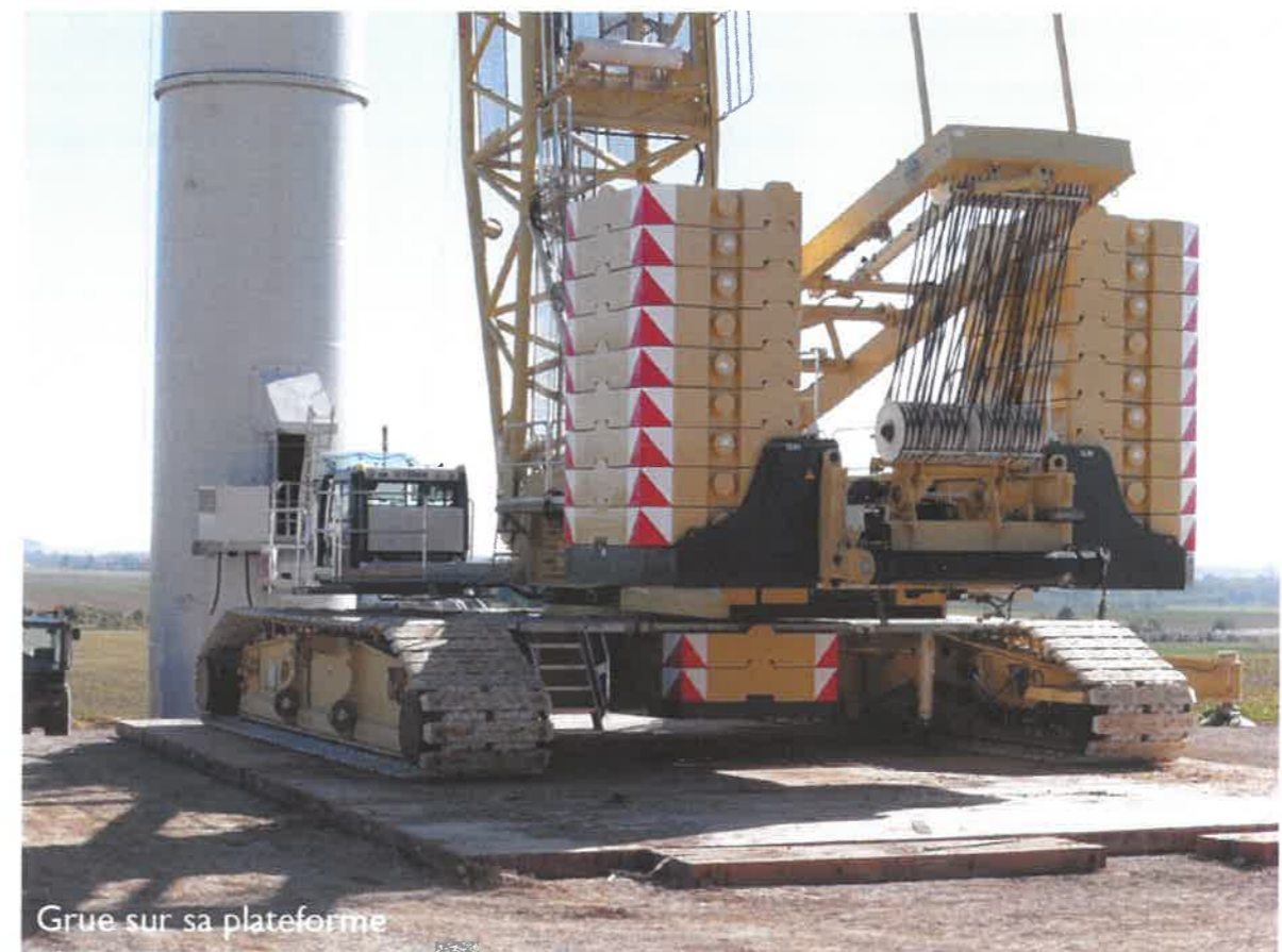
Figure 338 : Illustration d'une grue sur plateforme de montage utilisée pour l'assemblage des éoliennes
