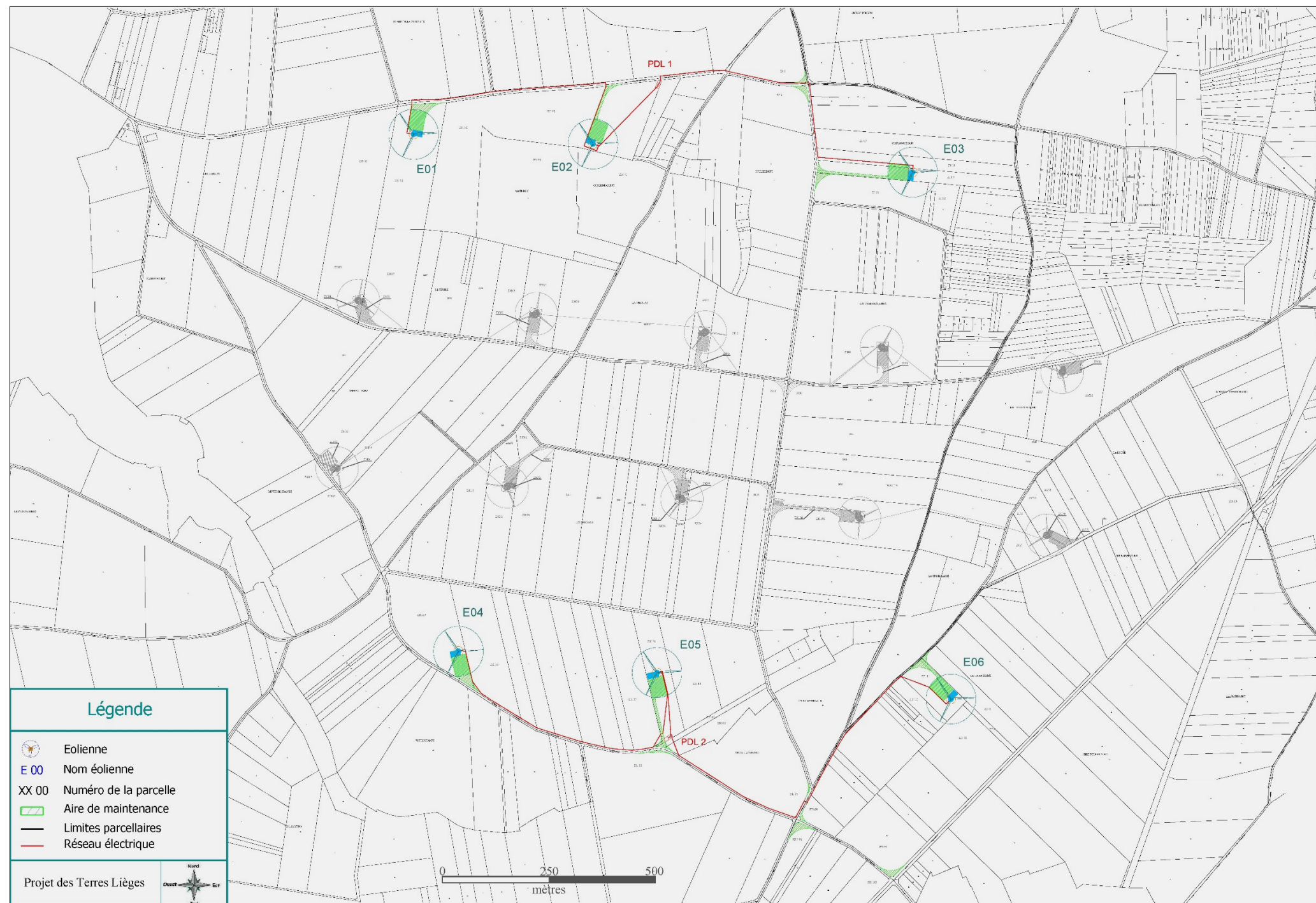
Carte 3 : Accès prévisionnel aux aires de maintenance des éoliennes
