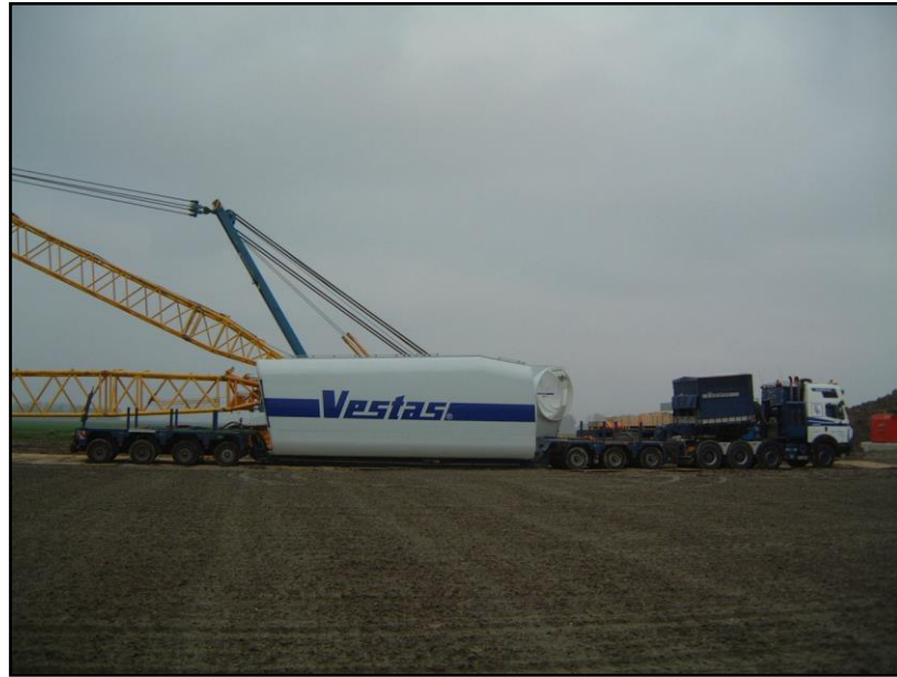
Photographie 6 : Transport de la nacelle
