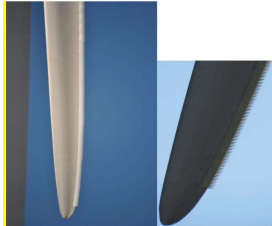
Photos des « peignes » sur des pales d'éolienne (source : Vestas)
