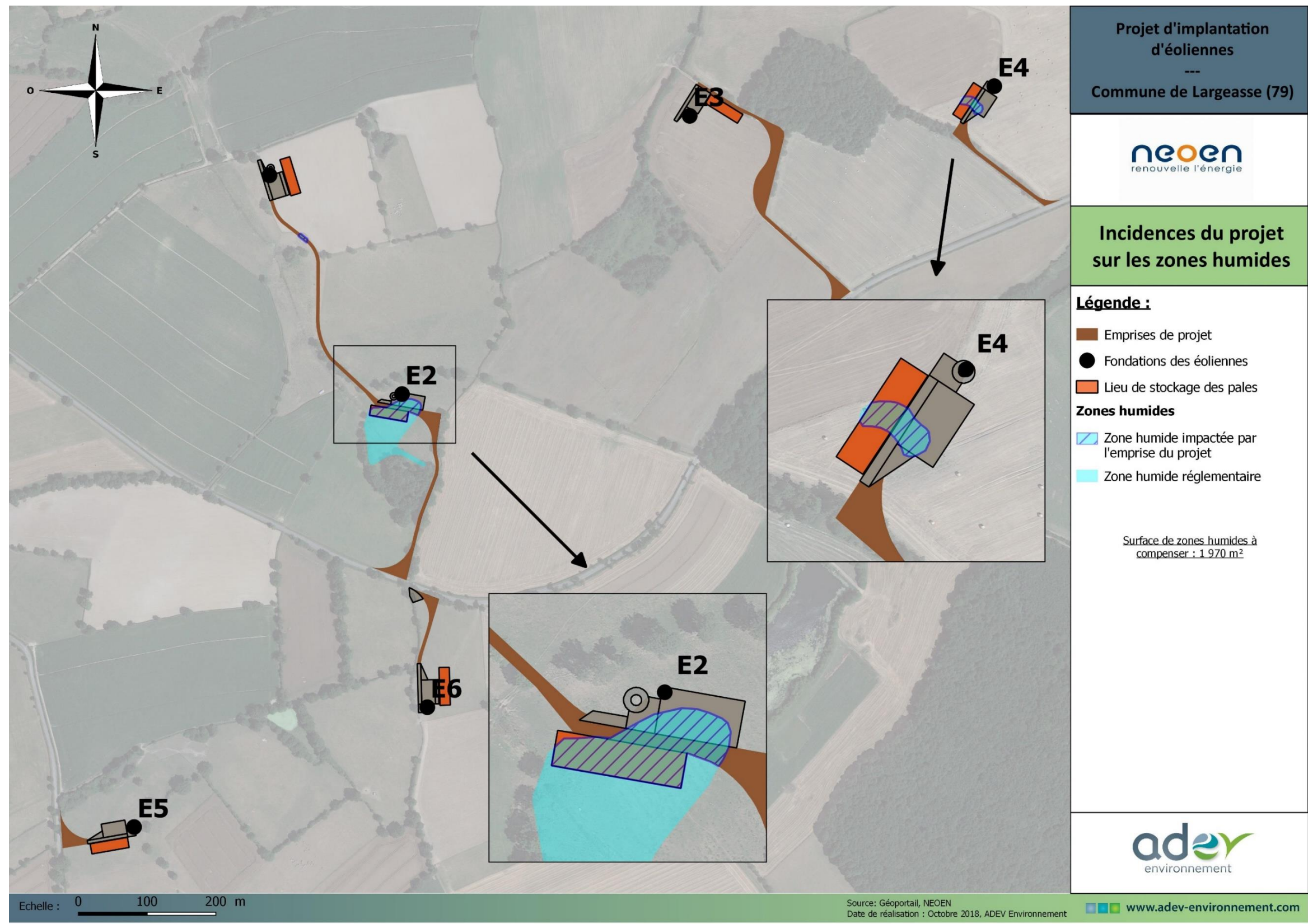
Illustration 176 : Incidences du projet sur les zones humides inventoriées (source : NEOEN, Adev environnement)
