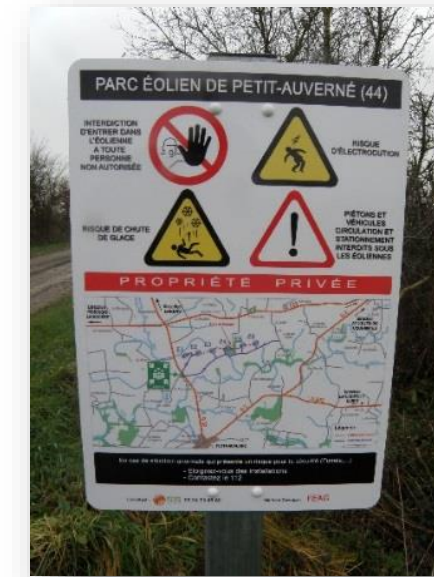
Figure 24 : Exemple de panneau d'affichage de sécurité présent aux abords des éoliennes
