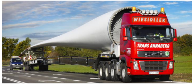
Figure 132 : Véhicule évolutif employé pour le transport de pale
