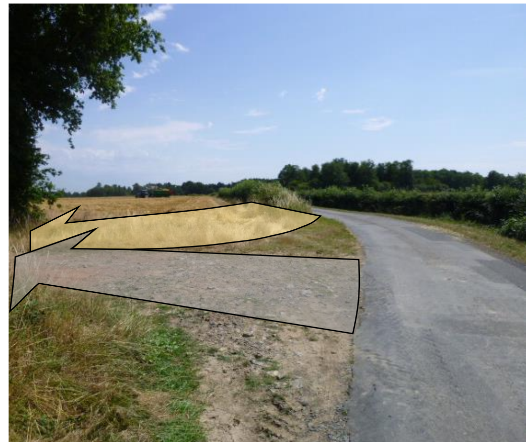
Figure 147 : Virage à aménager et chemin à rénover pour l'accès à l'éolienne E5
