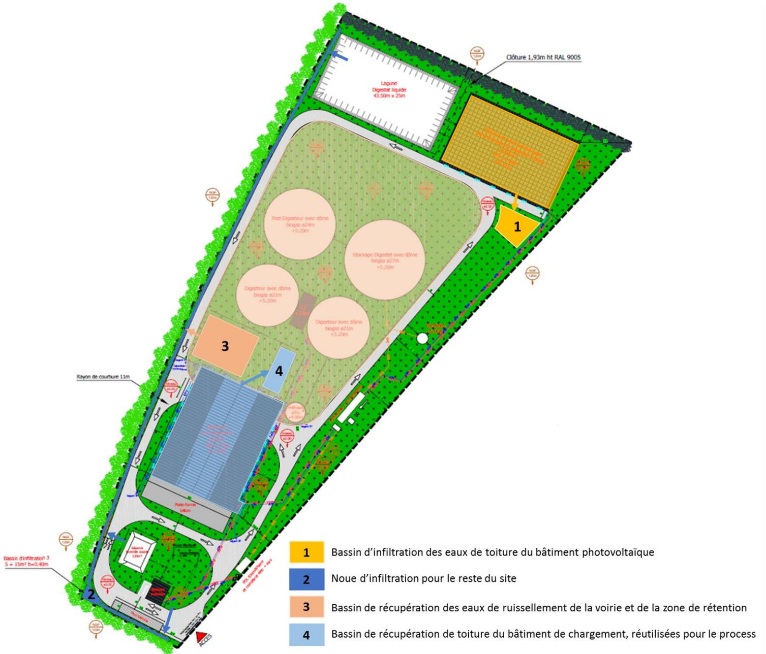
Figure 32 : Schéma de gestion des eaux pluviales
