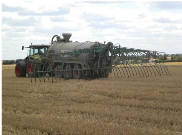
*Tonne à lisier équipée d'une rampe à pendillards
