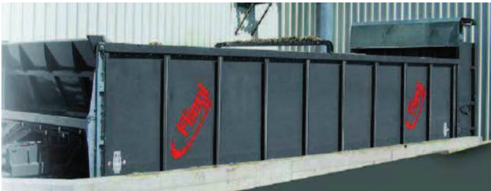
Figure 1 : Trémie d'incorporation avec fond poussant
