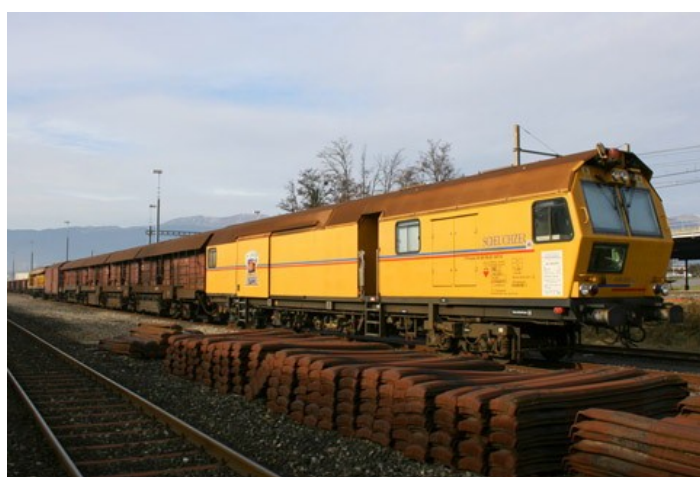
Train meuleur de rails (Scheuchzer S.A.)
