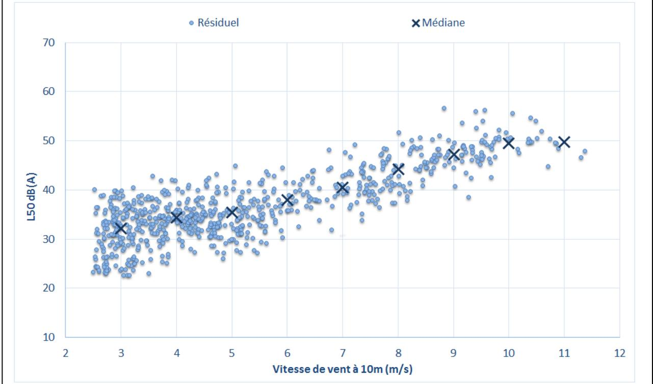
Figure 10 : Bruit en fonction de la vitesse de vent au point P6 – Mesures hivernales
