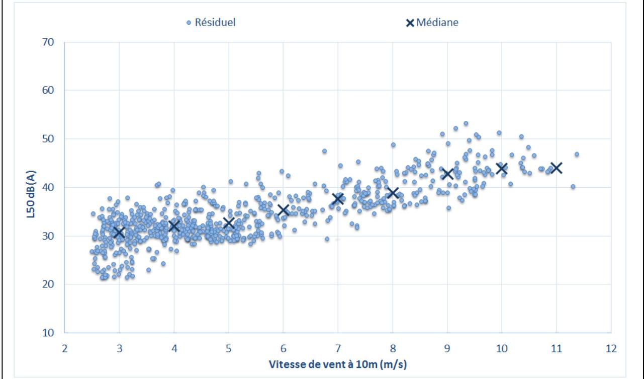
Figure 8 : Bruit en fonction de la vitesse de vent au point P4 – Mesures hivernales
