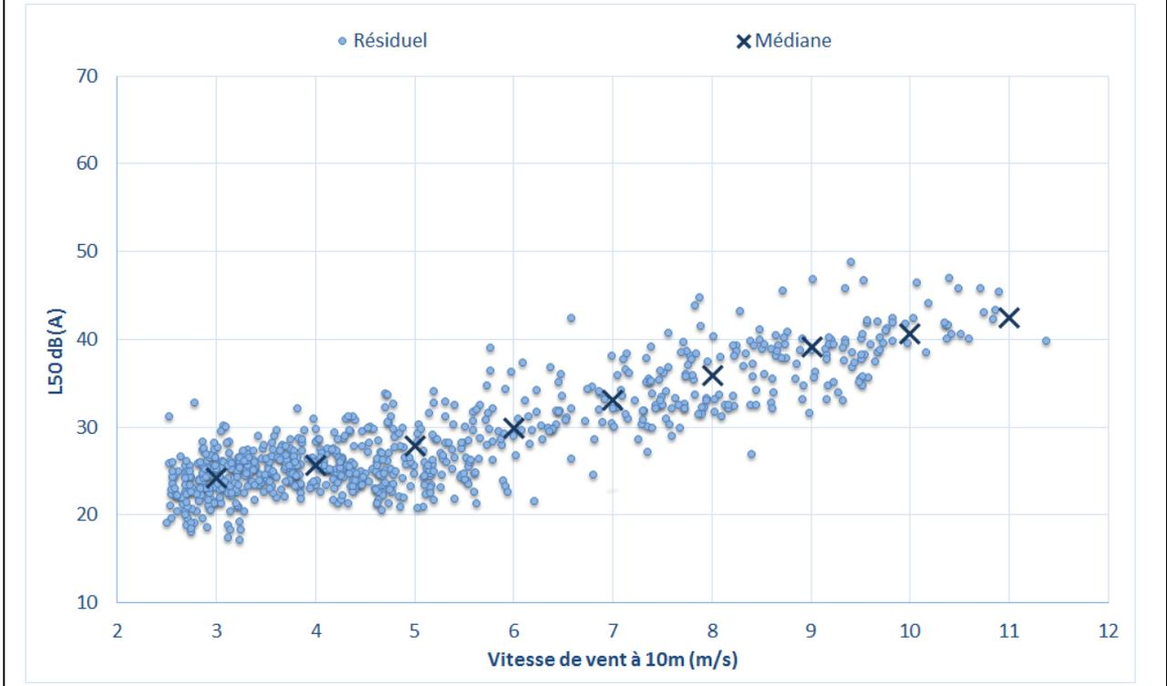
Figure 11 : Bruit en fonction de la vitesse de vent au point P7 – Mesures hivernales
