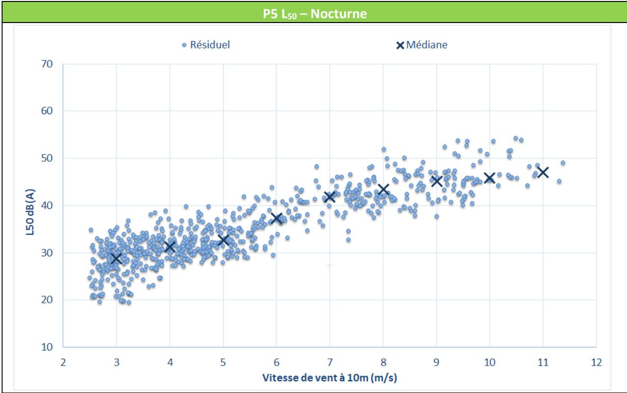
Figure 9 : Bruit en fonction de la vitesse de vent au point P5 – Mesures hivernales
