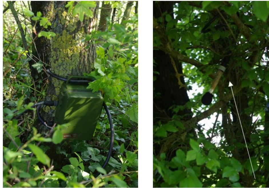
Figure 10 : Installation d'enregistreur continu SM4BAT+ (à gauche le SM4BAT et à droite l'emplacement du micro)
