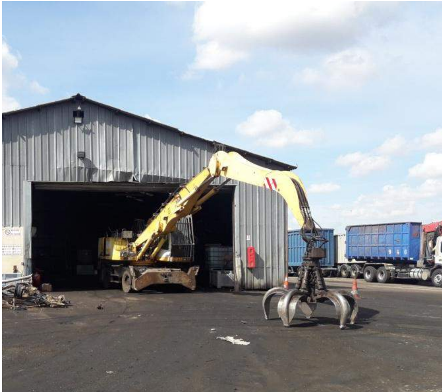
Grue avec grappin à ferraille du site de Niort
