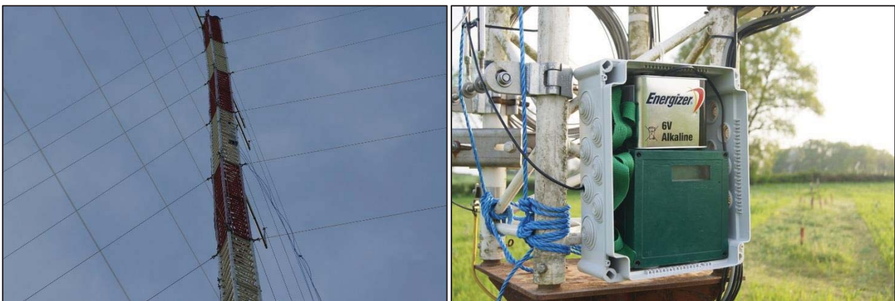
Figure 4 : Dispositif d'enregistrement de l'activité chiroptérologique installé sur le mât de mesure de vent
