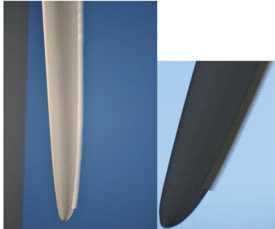
Illustration 211 : Photos des « Peignes » sur des pales d'éolienne (Source : Vestas)
